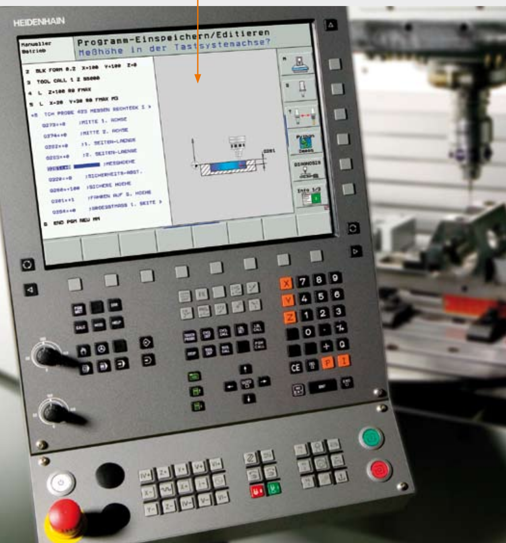
Cycle TNC: Initialisation du point d'origine sur une pièce alignée.
