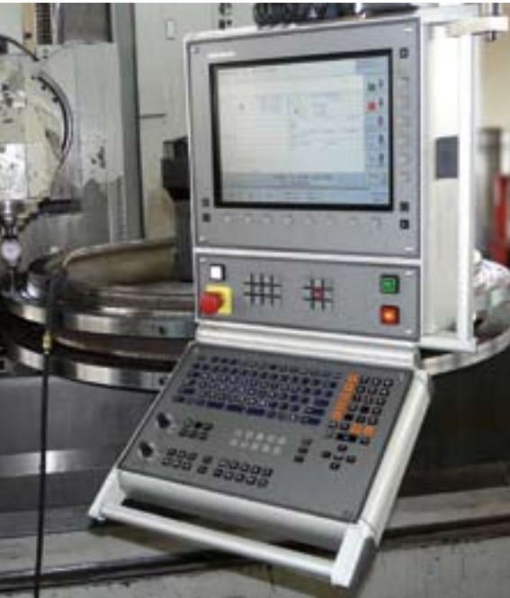
Bearbeitung einer 8 Tonnen schweren Generatorwelle auf der iTNC 530 gesteuerten Zayer Lateralfräsmaschine
