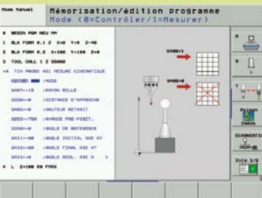
Nouvelle fonction KinematicsOpt: Etalonnage automatique de cinématique et recalibrage automatique de la cinématique de la machine
