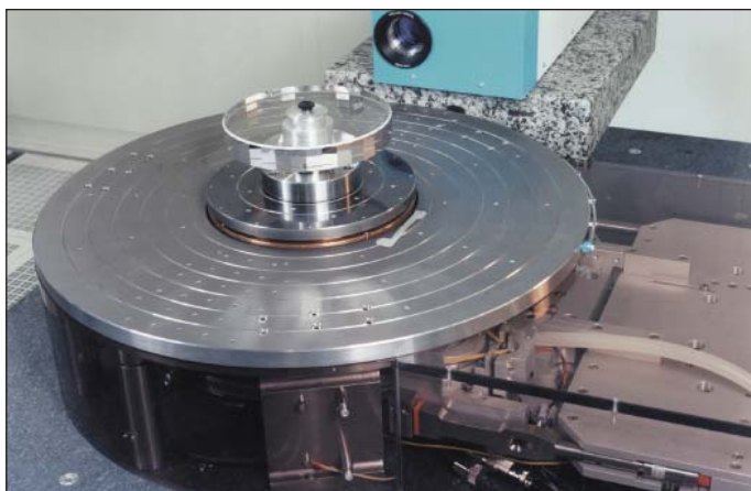
Comparteur angulaire, résolution de mesure env. 0,001 °
